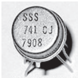
Наиболее успешная на сегодняшний день аналоговая интегральная схема. Операционный усилитель \mu A741 фирмы Fairchild, изготовленный в конце 60-х гг. XX века
